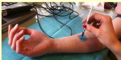
Application de 200 µL de solution sur 10 cm<sup>2</sup> de peau (5µg/cm<sup>2</sup> de colorant)
